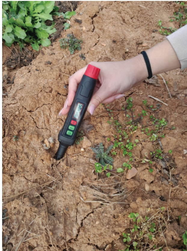
Fig. 16 – Misurazioni locali di temperatura ed umidità del suolo attraverso l'igrometro da campo.
