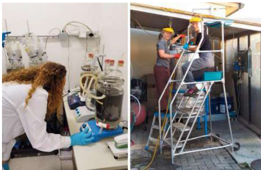
Figura 8: Realizzazione di prove di digestione anaerobica con biochar a scala laboratorio (a sx) e a scala pilota (a dx) presso la sede sperimentale di RE-CORD.
