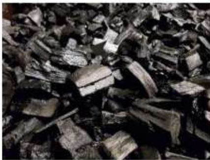
Figura 3: Esempio di biochar prodotto da biomassa legnosa (cippato di pioppo) (a sx); dettaglio della struttura porosa interna di un biochar prodotto da pino nero (a dx).
